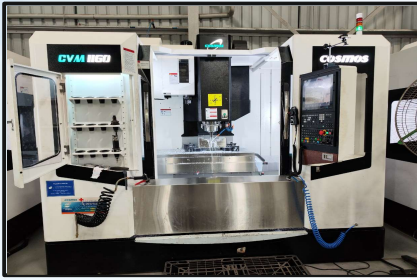
COSMOS CVM-1160 - 4 Machine X - Travels : 1250 Y - Travels : 650 Z - Travels : 600
